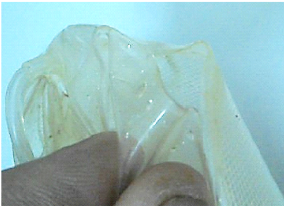
Figura 111: ruptura de expansor salino redondo con válvula remota.
